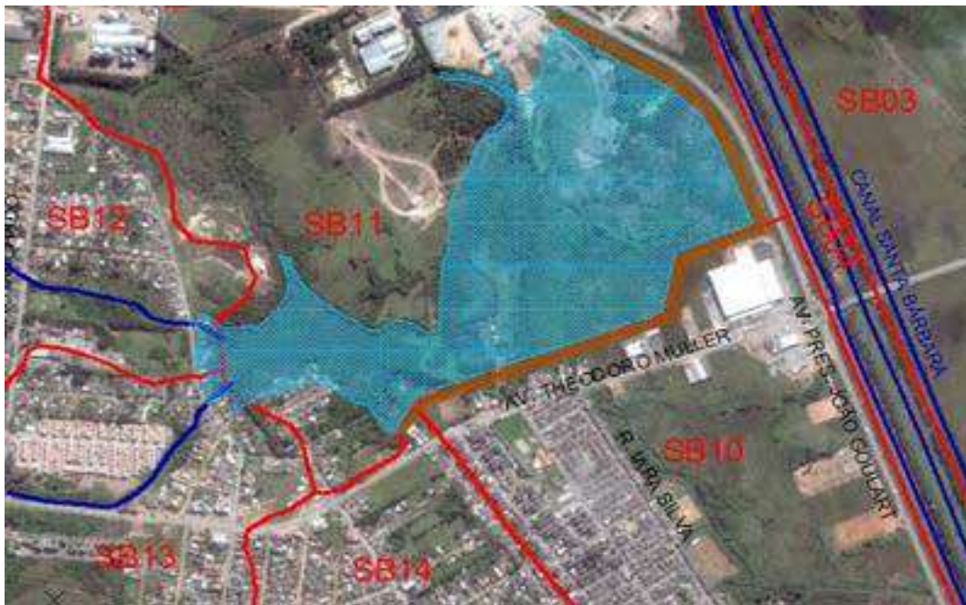
Figura 40: Proposição 2 - Reservatório na cota de coroamento 5,0 m.
