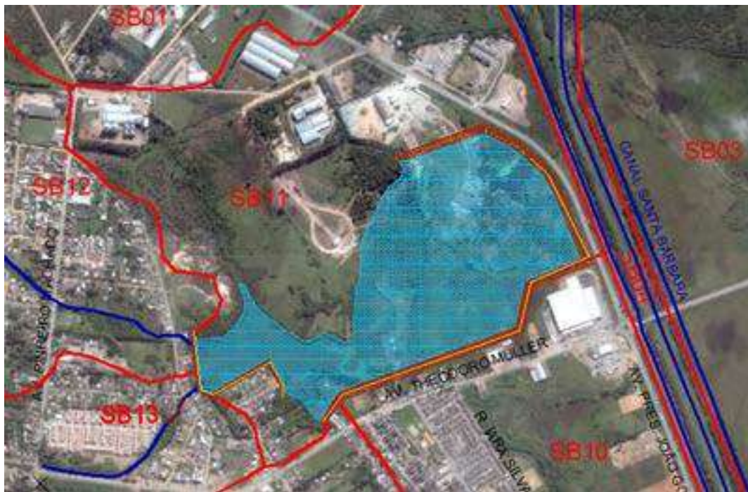
Figura 39: Proposição 1 - Reservatório na cota de coroamento 6,0 m.
