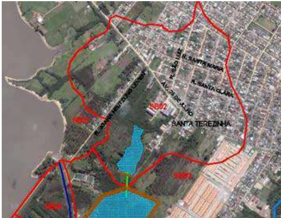
Figura 46: Proposição da Sb-02 com conduto forçado até Reservatório de Detenção na Sb-03.
